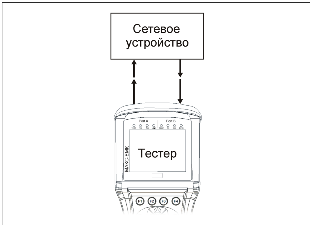
Рисунок 10.7. Схема «В» подключения прибора в режиме однонаправленного тестирования
